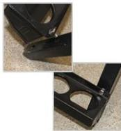
Fixe o apoio dos tubos na extremidade inferior do suporte
